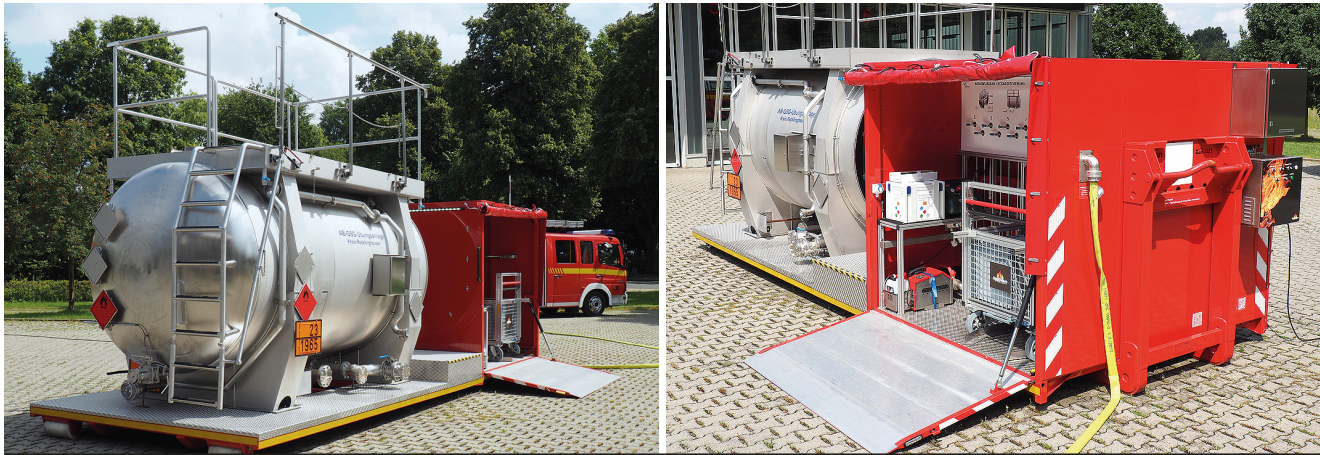
links: Blick auf den Abrollbehälter in Fahrtrichtung rechts mit der Tankatruppe, welche über das Heck begehbar ist, und dem Geräteraum rechts: Der Geräteraum beinhaltet alle zum Betrieb der Übungsanlage erforderlichen Materialien und Gerätschaften. Im Frontbereich sind der Schalt- und Sicherungskasten mit Batteriepufferung und weiterer externer Stromeinspeisung, der fest montierte Leitungsroller sowie der C-Eingang verbaut.
