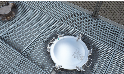
Die Oberseite der Tankattrappe ist wirklichkeitsgetreu dargestellt und verfügt neben einem verschlussfähigen Überlaufkasten über ein Mannloch und einen Einschweißflansch analog einer Gaspendelleitung.
