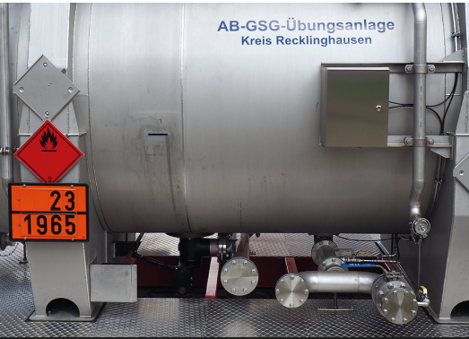
Attrappe eines Tankfahrzeugs mit pneumatisch betriebem Bodenventil
